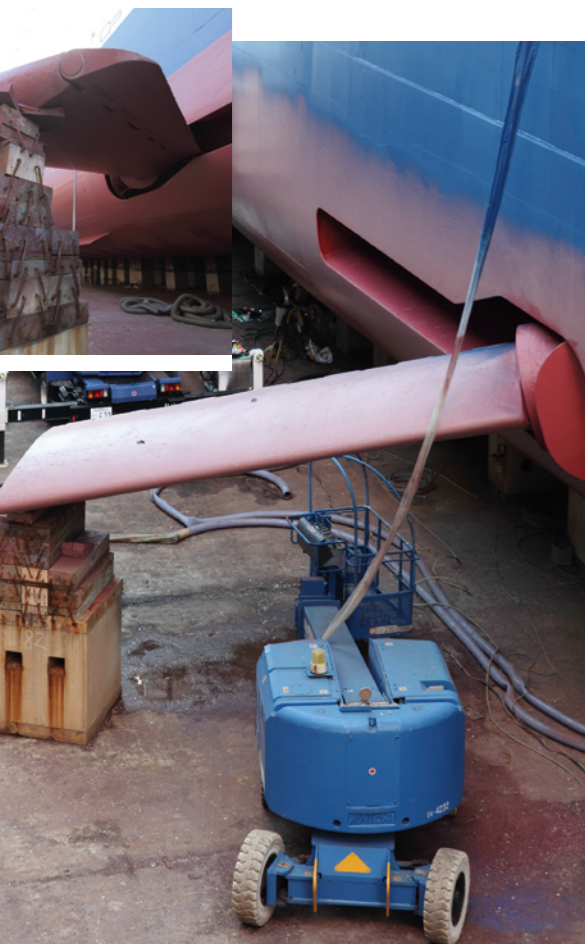
船の揺れを抑えるフィンスタビライザーは海の状態に応じて出し入れ。片側だけ出しても7割の効果があります。船底全体の赤い塗装は汚れとフジツボの付着を抑えます。
