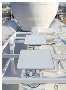
スペースX社の衛星ブロードバンド「Starlinkマリタイム」のアンテナを設置。より高速で快適なWi-Fi環境をご提供します。
