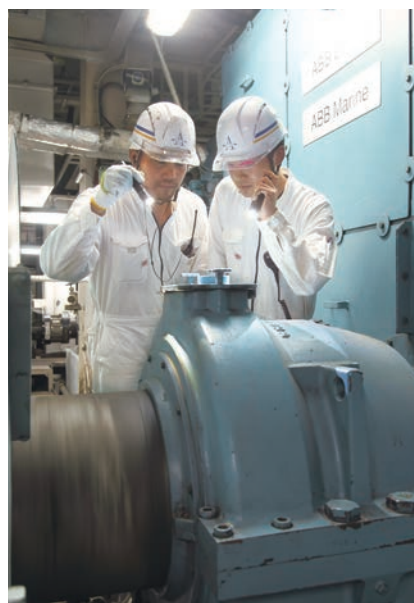
推進モーターをチェック、この右側（船外）にプロペラがあります
